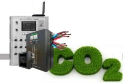
**통합환경제어기**(integrated greenhouse controller)통합제어시스템으로부터 받은 명령을 구동기 노드에 전달 또는 작동시키고 센서 노드로부터 전송된 값을 통합제어시스템에 전달.
